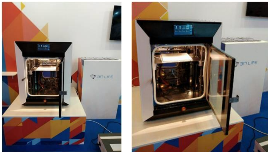
Рисунок 6 – 3D-принтер 3DLIFETHERMO с термостатичной камерой и экструзионным блоком с жидкостным охлаждением
